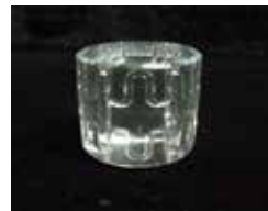
ガラスの中に溝(マイクロ流路)を封入する新技術。
