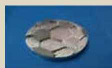
食用パンのサッカーボール の焼き印(三次元設計・三次元加工)
