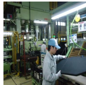
デッキボード成形工程
