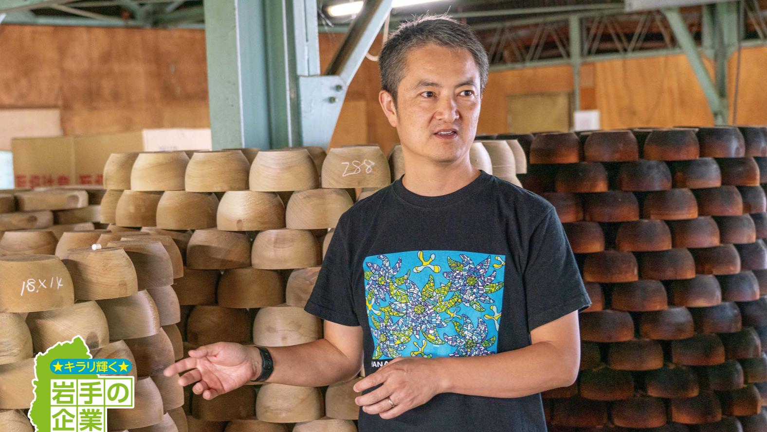
木地は燻煙乾燥させてから成形する。ろくろ成形時に出た木屑は燻煙する時の焚き付けに。無駄がない。
