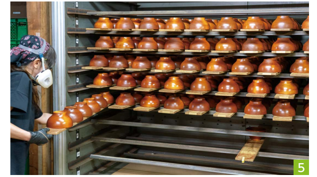
4 重ね塗りする塗料は全て異なる。塗料同士の定着を良くするため、乾燥後にヤスリがけを行う。 5 性質の異なる塗料を重ね塗りすることで、艶だけでなく肉厚感や耐久性が生まれる。
