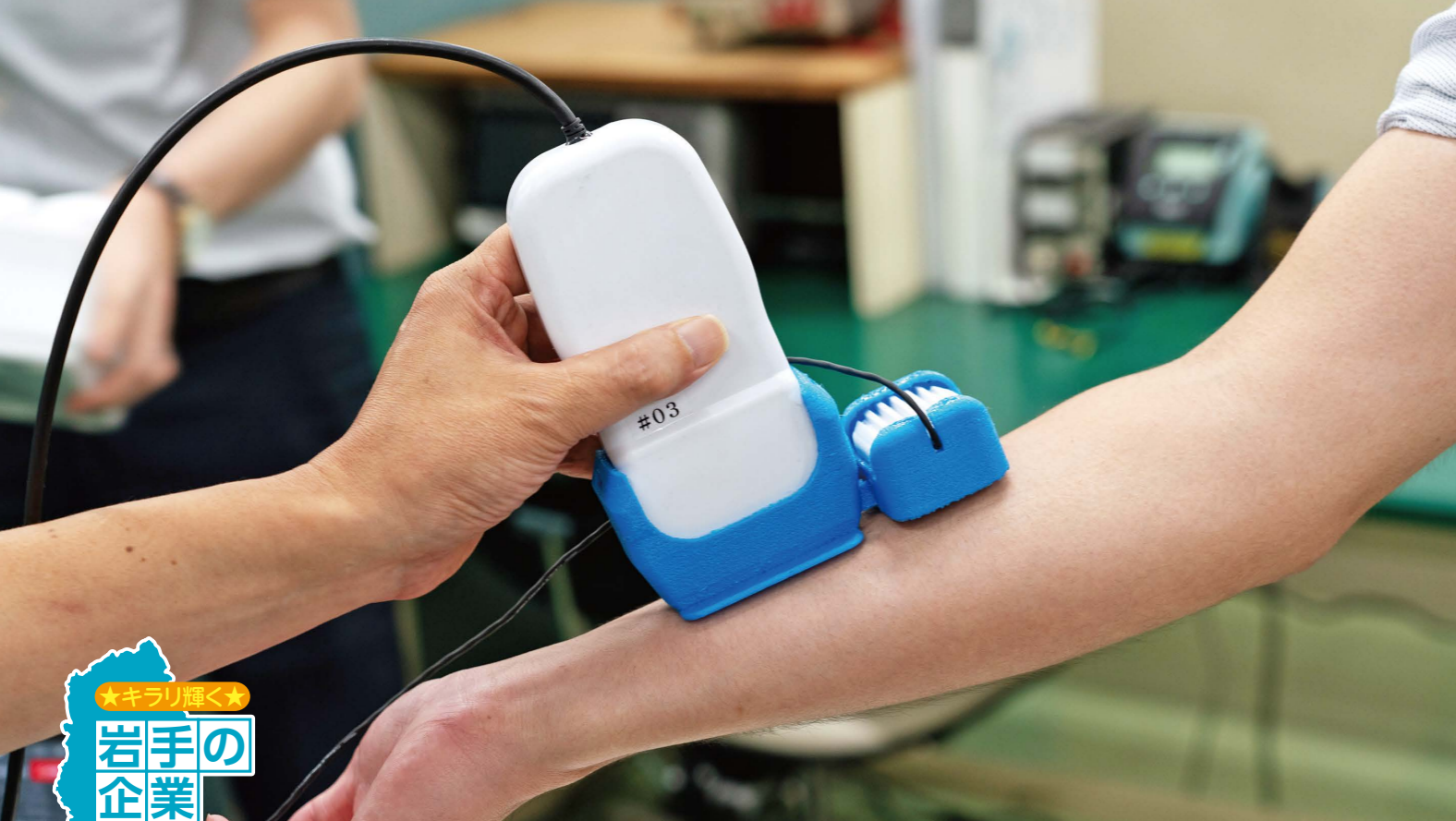
超音波プローブ。右側に装着した小型の加振器でせん断波を発生させ、超音波の映像に加えて「硬さ」を測定できる。
