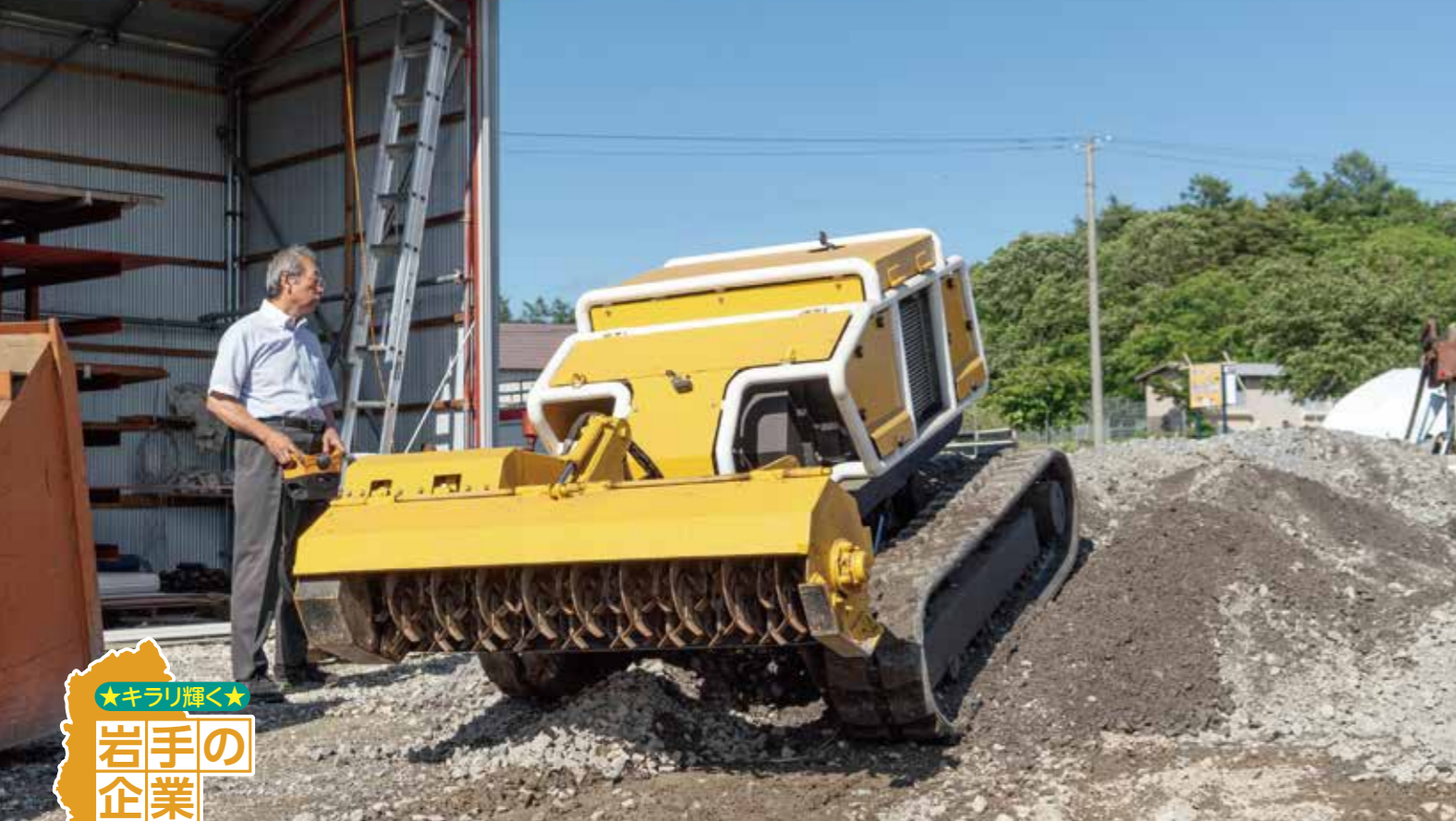
ハイドロマチック・モア/ラジコン操作であらゆる地形に対応できる。雑木を刈り、粉碎して外に出す仕組みだ。
