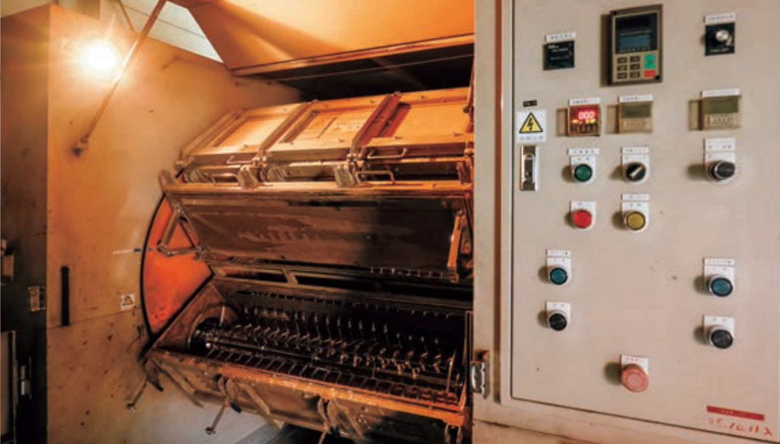
輝きを出すため、遠心バレル研磨機を使って磨く。研磨材はクルミの殻
