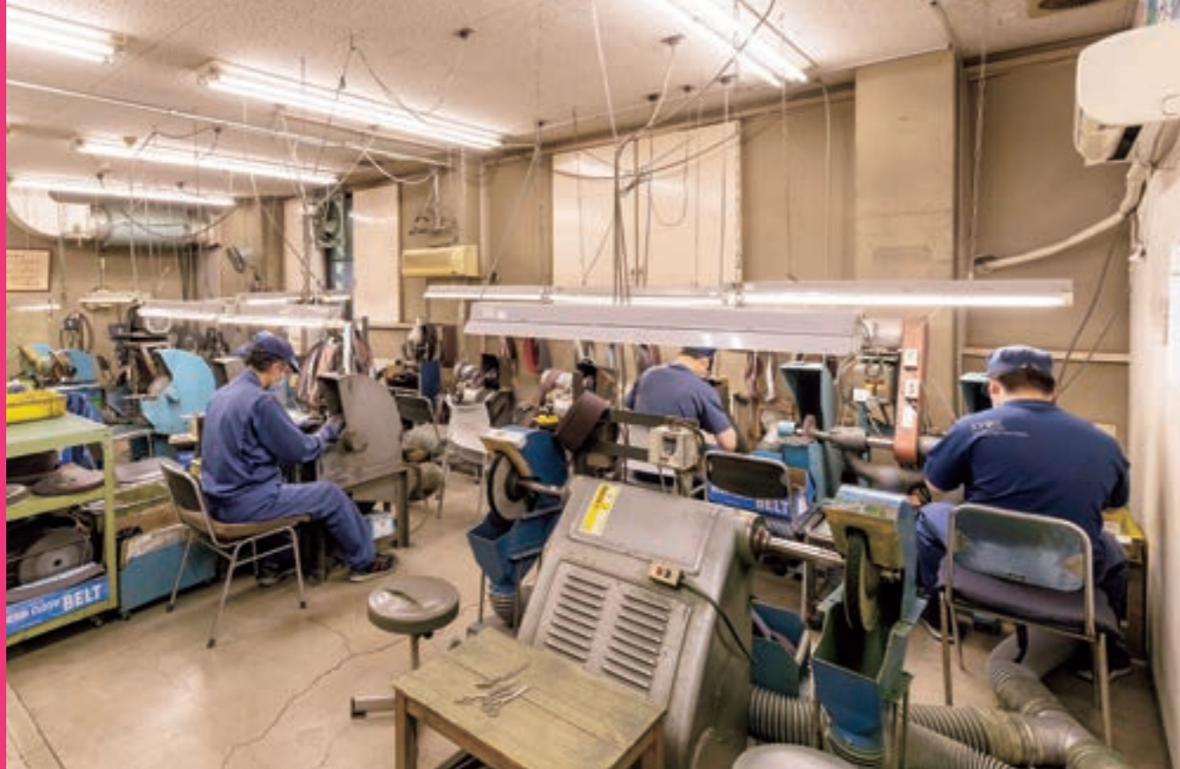
ヤスリの高速ベルトを使って表面の研磨作業が行われている一角
