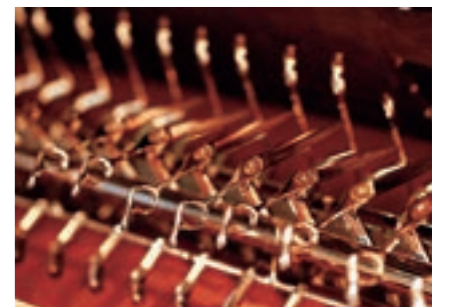
アームに刃を1枚ずつ取り付けて、研磨機にセットする。その後、2時間回転させて磨く仕組みだ
