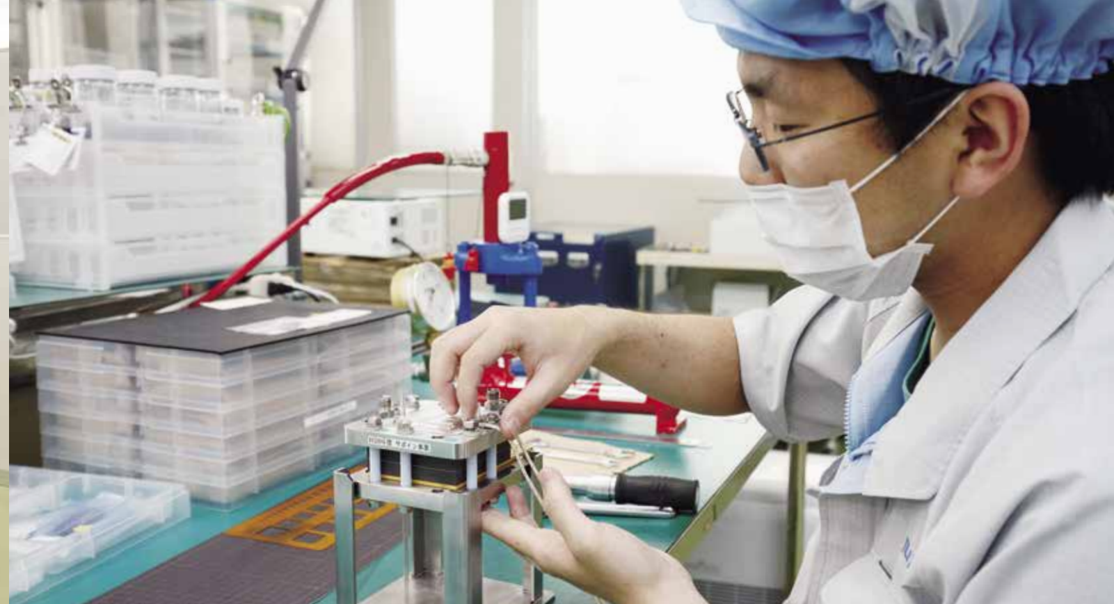
研究用の燃料電池単セル(JARIセル)を組立中
