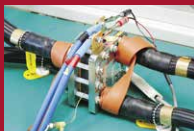
写真は、燃料電池で使用する低白金触媒の発電試験。白金の使用量を低減し、一酸化炭素に高い耐性を持ち、高効率な発電が可能
